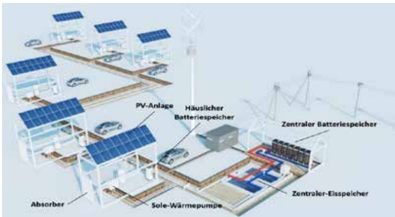
Abbildung 4: Kalte Nahwärme mit einem Stromspeicher
